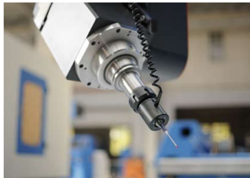
Obrabiarki CNC Kimla mogą być wyposażone w głowicę skanera dotykowego lub laserowego.
