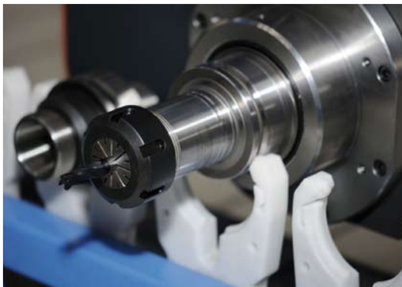
Liniowy magazyn narzędziowy pozwala na szybką wymianę narzędzi w trakcie pracy maszyny.
