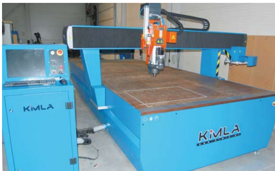
Centra do nestingu firmy Kimla są wyposażone w dwustrefowe stoły próżniowe. FOT. JANUSZ BEKAS
