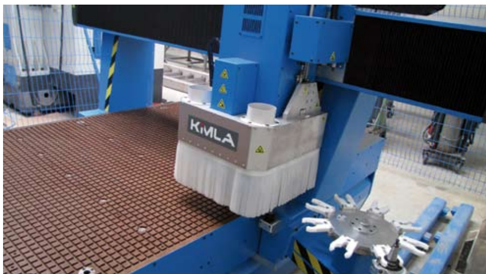
Wrzeciona montowane w centrach CNC mają moc od 7 do 20 kW. FOT. PRZEMYSŁAW KIMLA
