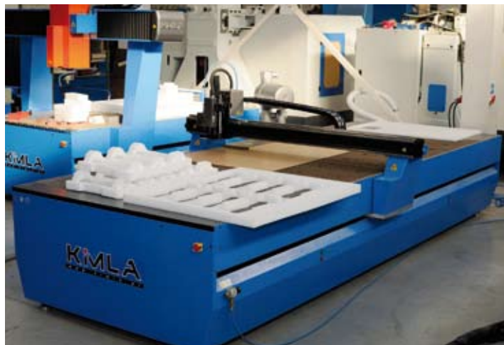
Cuttery firmy Kimla można wykorzystać w firmach tapicerskich do cięcia pianek poliuretanowych. FOT. KIMLA
