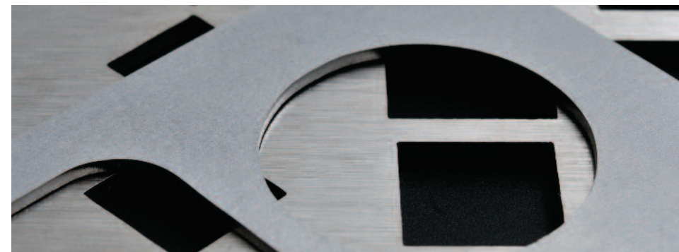
Laser światłowodowy jest w stanie szybciej niż laser CO 2 wycinać elementy z cienkich blach.
