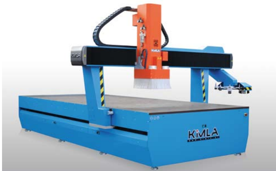
Centra obróbcze firmy Kimla umożliwiają wykonywanie na przykład gotowych frontów mebli kuchennych bez konieczności wstępnego formatowania płyt.
