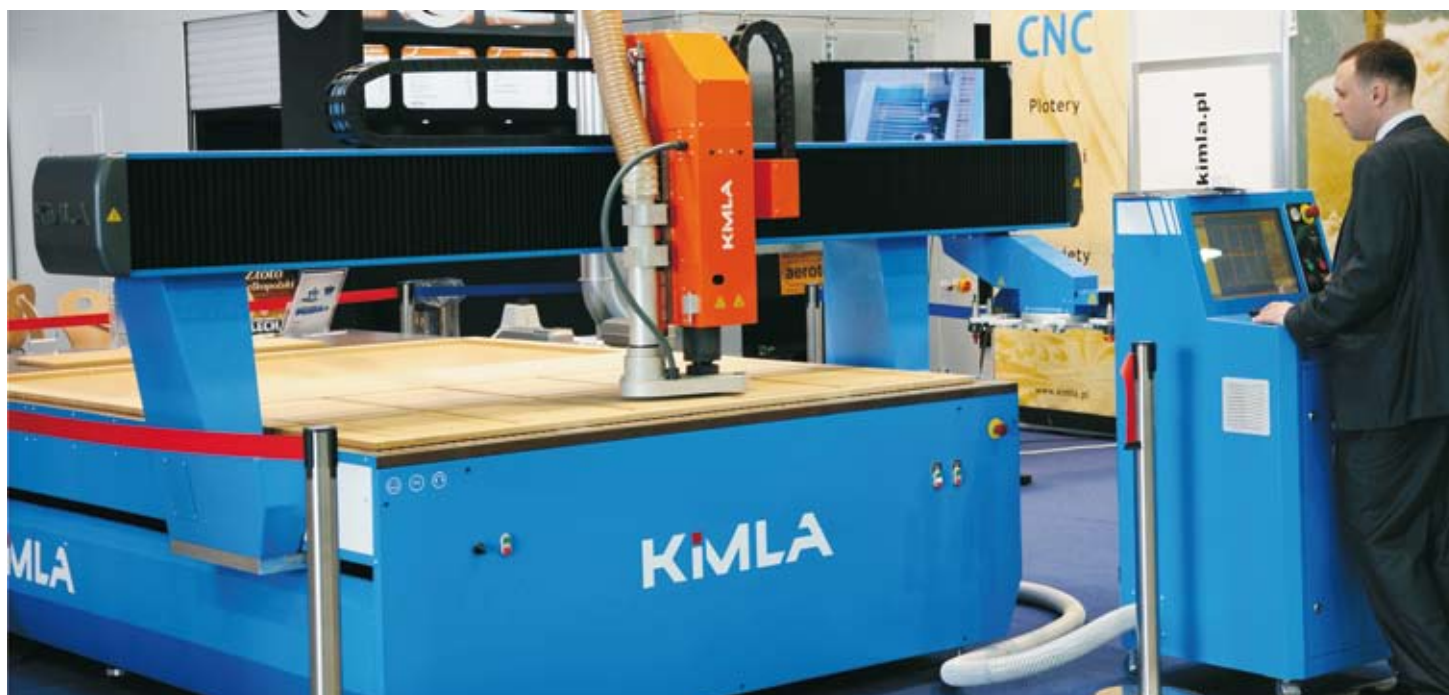
Stopa odciągowo-dociсковą przechwytuje pył i najdrobniejsze drobiny bezpośrednio z okolicy narzędzia. FOT. KIMLA
